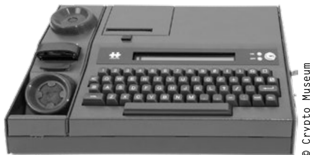
Abb. 2: Die elektronische Chiffriermaschine HC-530, von der Crypto AG in den späten 1970er Jahren entwickelt, verwendet einen von der NSA entwickelten kryptographischen Algorithmus. Alle Kunden außer den NATO-Staaten, der Schweiz und Schweden erhielten Geräte mit einem Hintertürchen.
